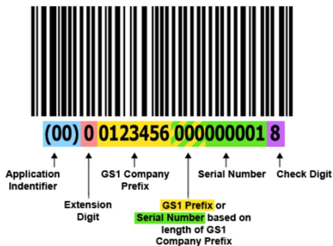
Figura 6: Exemplo SSCC codificado em código de barras GS1-128 com a indicação dos dados codificados.
